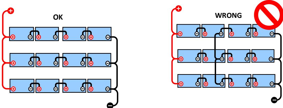
Aufgrund des Spannungsabfalls über das positive und das negative Kabel sind die Mittenspannungen nicht identisch.
