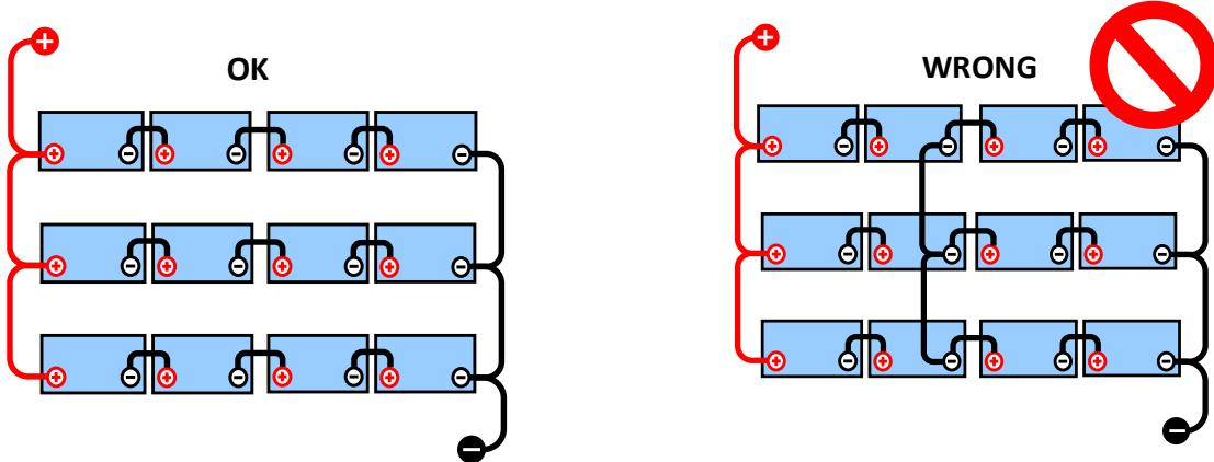
Devido à queda de tensão nos cabos positivo e negativo, as tensões do ponto médio não são idênticas.
