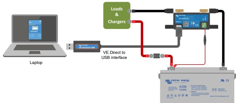
Pour une connexion via USB, vous aurez besoin d'une « Interface VE.Direct-USB » dont la référence est SS030530000. Utilisez cette interface pour connecter l'ordinateur au SmartShunt.
