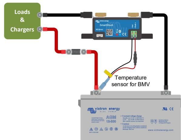
Tenga en cuenta que si se usa el sensor de temperatura, los cables de alimentación rojos que vienen con el SmartShunt no son necesarios. El sensor de temperatura sustituirá a estos cables.
