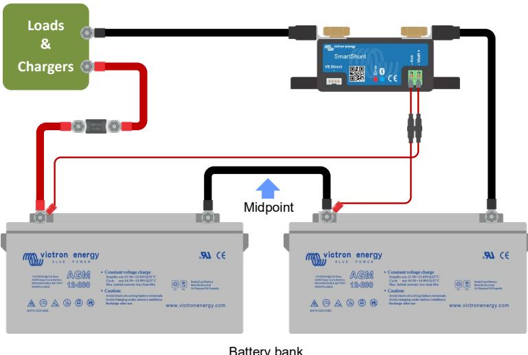
Per ulteriori informazioni riguardo il monitoraggio del punto medio, vedere il capitolo 9. Questo capitolo fornisce anche informazioni e schemi di cablaggio, riguardanti la modalità di monitoraggio del punto medio di banchi batterie cablati in serie/parallelo.
