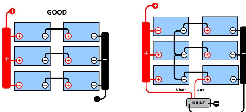
Use siempre barras de conexiones cuando haga un seguimiento de la tensión del punto medio. Todos los cables que vayan a las barras de conexiones deben tener la misma longitud.
