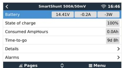
De SmartShunt kan worden aangesloten op een GX-apparaat met een VE.Direct-kabel, onderdeelnummer ASS03053xxxx. De VE.Direct-kabels zijn verkrijgbaar in lengtes variërend van 0,3 tot 10 meter en zijn verkrijgbaar met rechte of haakse stekkers. De SmartShunt kan in plaats van gebruik van een VE.Direct-kabel ook verbinding maken met het GX-apparaat via de VE.Direct-naar-USB-interface.
