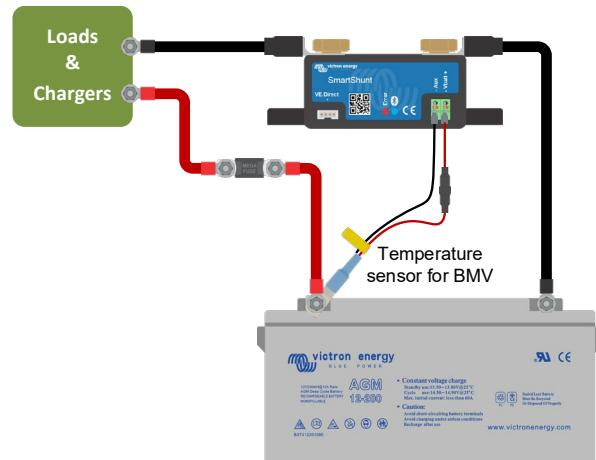
Observera att de röda strömkablarna som följer med SmartShunt inte behövs om du använder temperatursensorn. Temperatursensorn ersätter dessa kablar.
