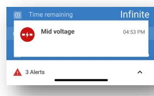
Nel caso della VictronConnect, è possibile confermare il riconoscimento dell'allarme premendo un pulsante.
