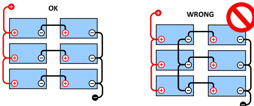
Door de spanningsval in de positieve en de negatieve kabels is de middenpuntspanning niet identiek.
