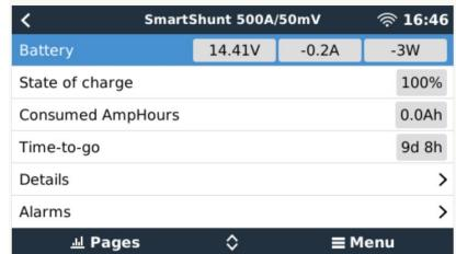
O SmartShunt pode ser conectado a um dispositivo GX através de um cabo VE.Direct, número de peça ASS03053xxxx. Os cabos VE.Direct estão disponíveis em comprimentos que variam de 0,3 a 10 m e com conectores direitos ou com ângulo reto. Em vez de utilizar um cabo VE.Direct, o SmartShunt também pode ser conectado ao dispositivo GX com a *interface* VE.Direct para USB.
