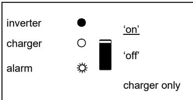
Der Inverter ist eingeschaltet und liefert Wechselstrom an die Verbraucher.
