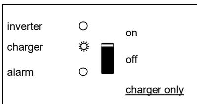
La tensión CA de entrada se activa y el cargador funciona en modo de flotación.
