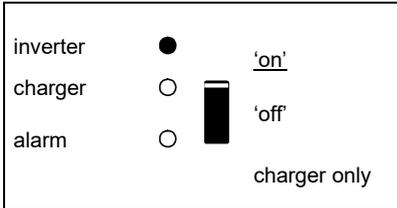
Der Inverter ist eingeschaltet und liefert Wechselstrom an die Verbraucher. Batteriebetrieb!
