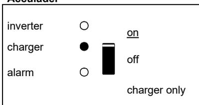
De netspanning is doorgeschakeld en de lader voert een bulk- of absorptielading uit.
