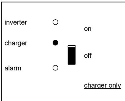
La tensión CA de entrada se activa y el cargador funciona en modo de carga inicial o de absorción.
