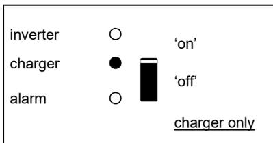
Die Netzspannung ist durchgeschaltet und das Ladeteil liefert Konstantstrom (bulk phase) oder Konstantspannung (absorption phase).
