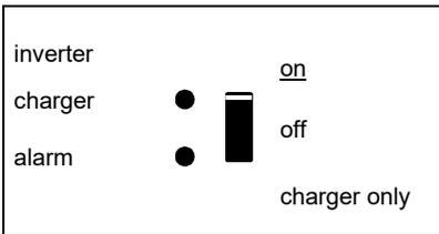
La tensione di ingresso in CA viene commutata e il caricabatterie è spento. Il caricabatterie non riesce a raggiungere la tensione finale di batteria (modalità di protezione della prima fase di carica).
