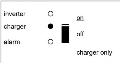
La tensione di ingresso in CA viene commutata e il caricabatterie lavora in modalità "bulk" (prima fase di carica) o "absorption" (assorbimento).
