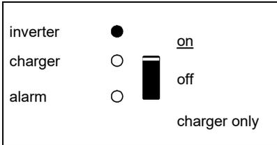
El inversor está encendido y suministra energía a la carga. Funcionamiento de la batería
