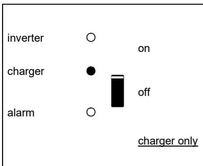
De netspanning is doorgeschakeld en de lader voert een bulk- of absorptielading uit.
