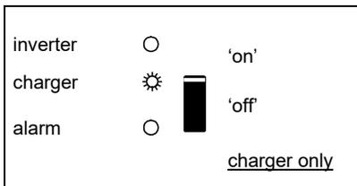
Die Netzspannung ist durchgeschaltet und das Ladeteil lädt mit Ladeerhaltungsspannung (float-Modus).
