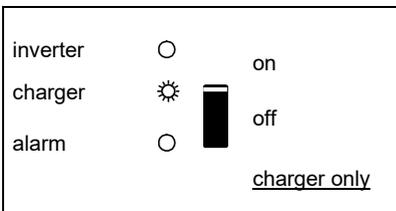
La tensione di ingresso in CA viene commutata e il caricabatterie lavora in modalità di mantenimento.
