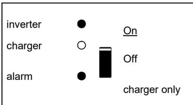
De omvormer is uitgeschakeld. Alarm: overbelasting, of accuspanning te laag, of omvormer temperatuur te hoog, of DC-rimpelspanning op accuklem was te hoog.
