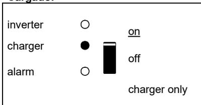
La tensión CA de entrada se activa y el cargador funciona en modo de carga inicial o de absorción.
