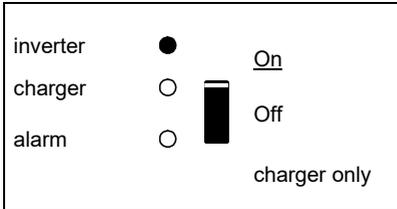
De omvormer is ingeschakeld en levert vermogen aan de belasting. Accu in bedrijf.
