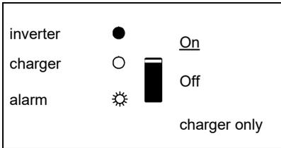
De omvormer is ingeschakeld en levert vermogen aan de belasting. Voor-alarm: overbelasting, of accuspanning te laag, of omvormer temperatuur hoog
